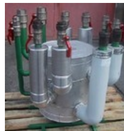
ZORTSTRÖM Multi s 3 vrstvami. Priemer 1800 mm, výška 2200mm, obsah 5160 l, vývody DN80 až DN300 Celkový výkon 11 MW - Bioenergia Wachterbach Na obrázku je vidieť obslužnú plošinu s prístupovým rebríkom a pomoc.konštrukcie.
