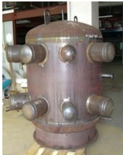
Centrálny zdroj – Melle Projekte Fischer s.r.o. Osnabrück. Skúšané TÜV prevádzková teplota 180°C
