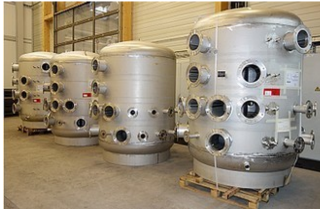
ZORTSTRÖM Multi – realizácia vo VW Emden materiál nerez
